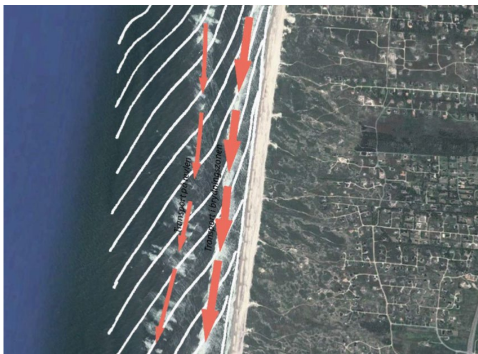
Figur 4.9 Bølger, som slår ind på en strand og driver en langsgående transport. Hvide linjer viser bølgetoppe. Orange pile indikerer langstransportens retning og størrelse.
